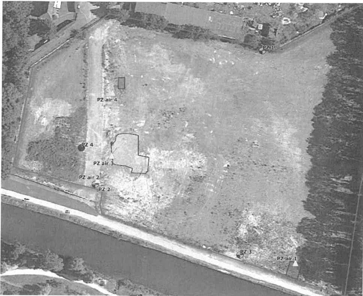
En cas de remplacement ou d'implantation de nouveaux piézomètres, les piézomètres sont réalisés conformément à la norme en vigueur (NF X31-614 ou équivalente). Les ouvrages sont référencés en coordonnées Lambert II étendues. Les têtes des ouvrages sont nivelées. Toutes les informations de niveaux (profondeur de l'ouvrage, niveau piézométrique) sont déterminées en côte NGF.
